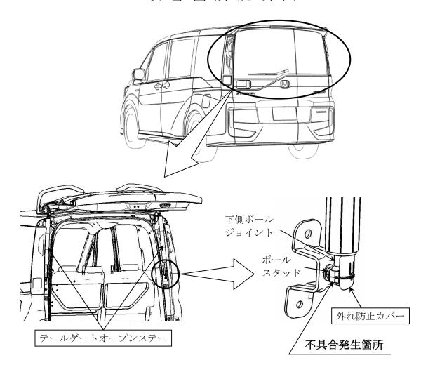
テールゲートオープンステーにおいて、下側ボールジョイントと車体側ボールスタッドの取付部構造が不適切なため、ボールジョイントとボールスタッドを固定するクリップが変形し、浮き上がることがある。そのため、そのままの状態で使用を続けると、テールゲート開閉の繰返しにより、ボールジョイントが車体から外れ、テールゲートが突然降下するおそれがある。
