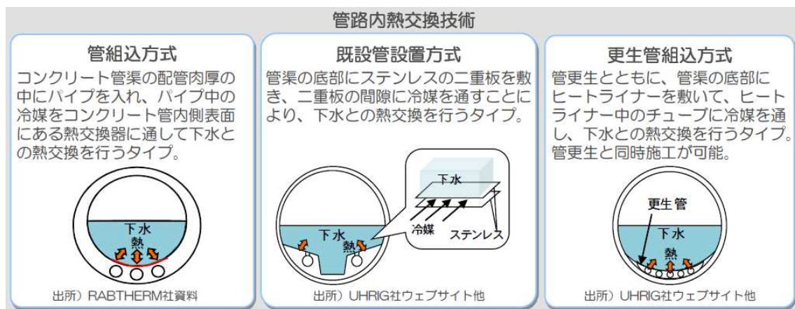
図 2-6 管路内熱交換技術の種類
