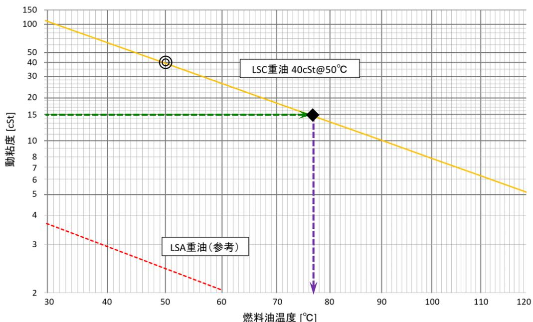
図2-C 動粘度-温度曲線 (Step 3)
