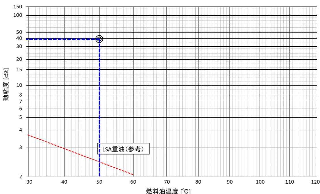
図2-A 動粘度—温度曲線(Step 1)
