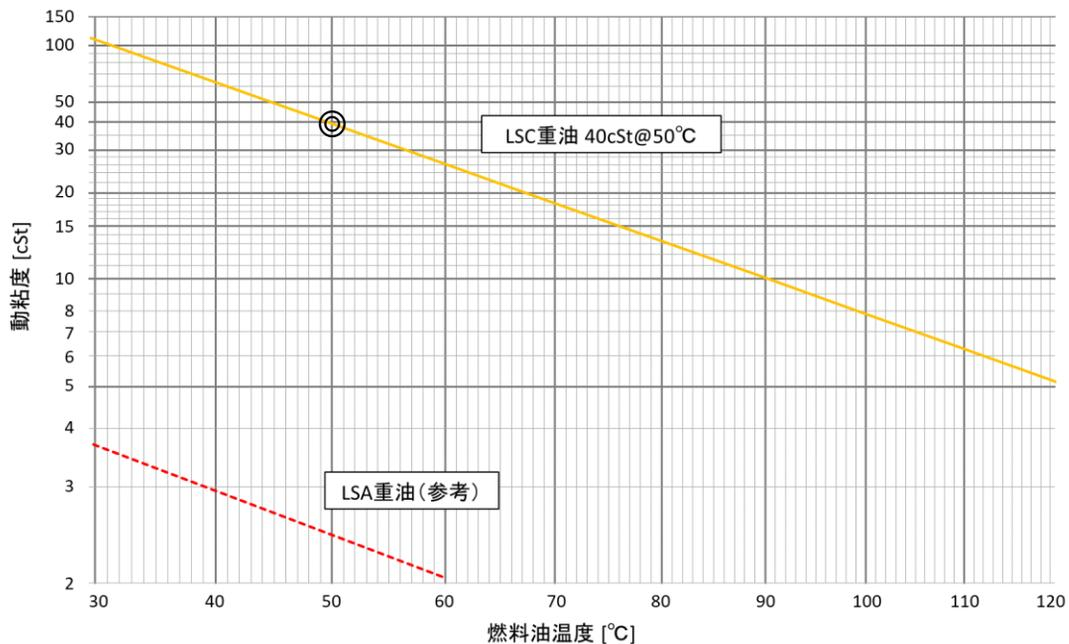
図2-B 動粘度-温度曲線 (Step 2)
