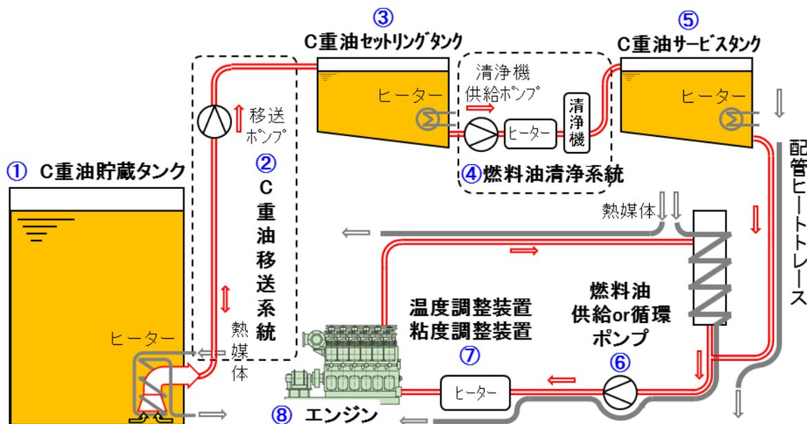
図3-1 内航船の一般的な燃料油システム
