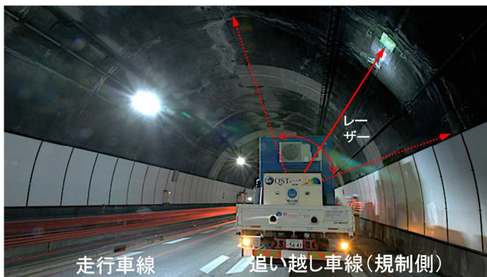
図 レーザー打音計測による計測の様子並びに計測結果
