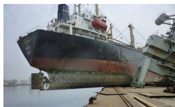
船舶の岸壁への乗揚げが発生 (仙台塩釜港)
