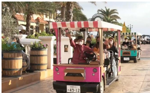
1人の遠隔監視・操作者が2台の無人自動運転車両を運行
