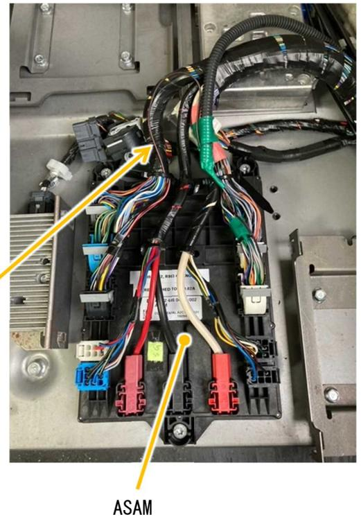
機械式自動変速機の大型トラックにおいて、イグニッションスイッチが不適切なため、イグニッション OFF 信号が発信される場合がある。そのため、突然エンジンが停止し、ライトスイッチをオート位置で使用していた場合は前照灯が消灯する等の不具合が生じるおそれがある。
