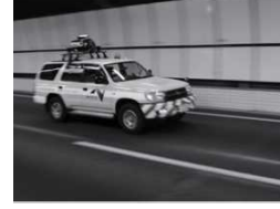
国土交通大臣賞 高速道路のトンネルにおける時速100km走行での覆工コンクリート高解像度変位検出手法 東京大学・中日本高速道路㈱
