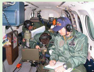
くにかぜⅡ機内 : 機器に囲まれ狭い作業スペース。ファインダーで地上を見ながら撮影。
