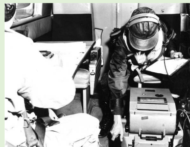
初代くにかぜ機内 : 測量用大型カメラ使用
