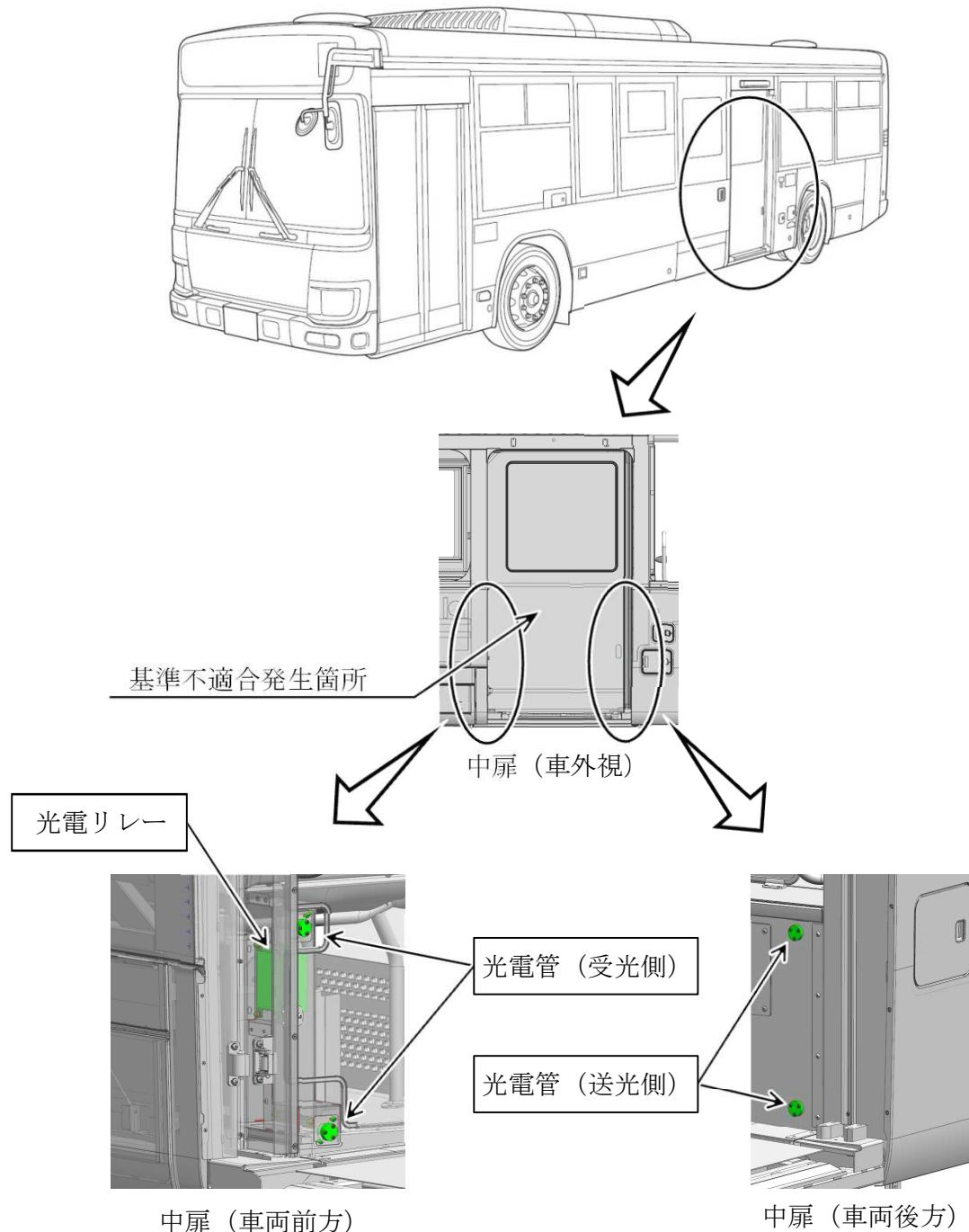
バスの乗降開閉機構の検知器（光電装置）において、光電管への外的要因に対する検討が不十分なため、水の付着や外乱光等により、当該光電装置が誤検知を起こし、扉が開閉できなくなるおそれがある。
