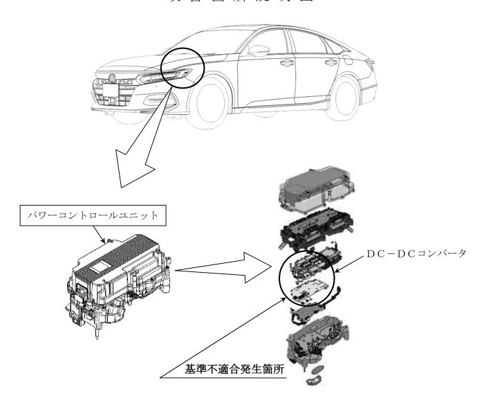
パワーコントロールユニットの電圧変換装置(DC-DCコンバータ)において、バッテリへの 供給電圧を制御する回路上の素子の製造管理が不適切なため、冷間始動後にフェールセーフモード へ移行して、バッテリへの給電を停止することがある。そのため、バッテリが充電不足となり、警 告灯、警告表示が点灯し、走行不能となるおそれがある。
