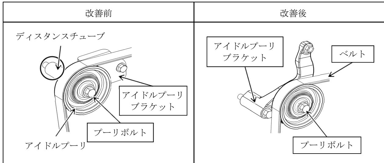
小型トラックの冷凍機架装車において、冷凍機アイドルプーリ締結部の形状が不適切なため、ベルト張力によりアイドルプーリボルトに過大な応力がかかり折損するものがある。そのため、ベルトが外れて冷凍機が作動しなくなり、最悪の場合、走行中プーリが路面に落下するおそれがある。
