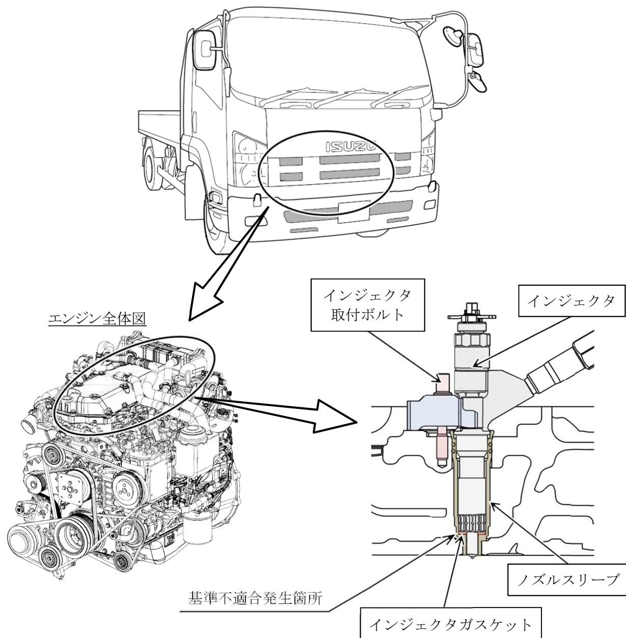
中型トラック及びバスの燃料噴射装置において、インジェクタ取付ボルトの締付トルク指示が不適切なため、インジェクタガスケットのシール性が不足しているものがある。そのため、燃焼ガスが漏れてインジェクタ取付ボルトが緩み、振動が大きくなつて当該ボルトが折損し、エンジンが停止して走行できなくなるおそれがある。
