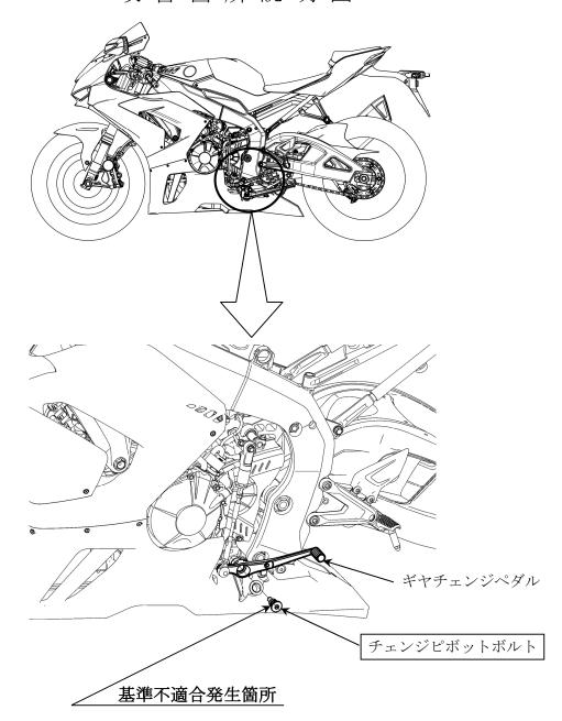
ギヤチェンジペダルにおいて、当該ペダルを車体へ取り付けるチェンジピボットボルトの取付方法が不適切なため、強いシフトアップの変速操作をすると、当該ボルトが緩むことがある。そのため、そのまま使用を続けると、ボルトが折損し、ギヤチェンジペダルが外れ、変速できなくなるおそれがある。
