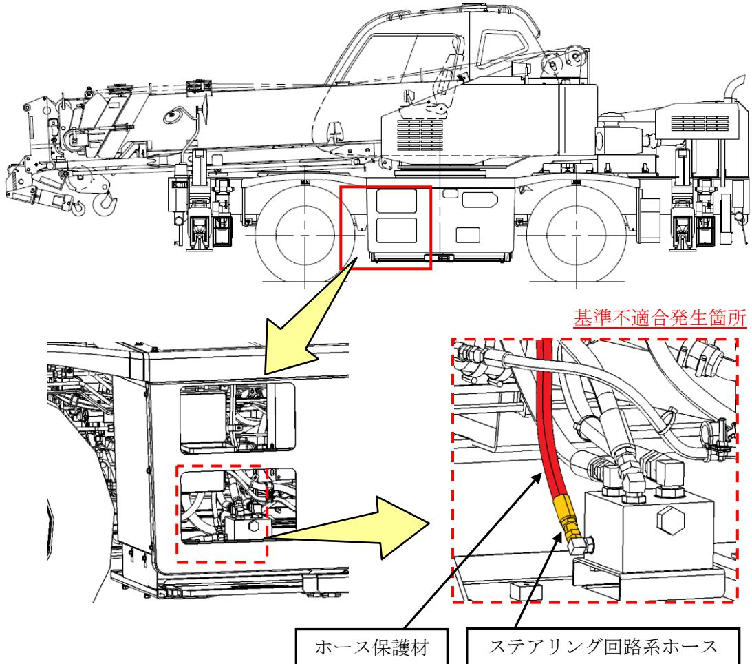
ホイール・クレーンの油圧ステアリング回路系ホースにおいて、ホース保護材の固定範囲が不適切なため、局部的な曲げ負荷が生じるおそれがある。そのため、そのままの状態で使用を続けると、繰り返し圧力によりホースが損傷し、作動油が漏れ、容易にステアリング操作ができないなくなるおそれがある。
