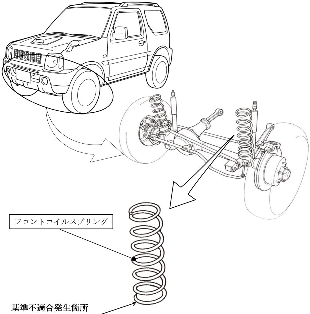
フロントサスペンションにおいて、コイルスプリングの鋼材に対する塗料の密着性が不足しているため、砂や小石を噛み込んだ場合に、塗装が剥がれやすく、腐食が早期に進行するものがある。そのため、最悪の場合、コイルスプリングが折損するおそれがある。
