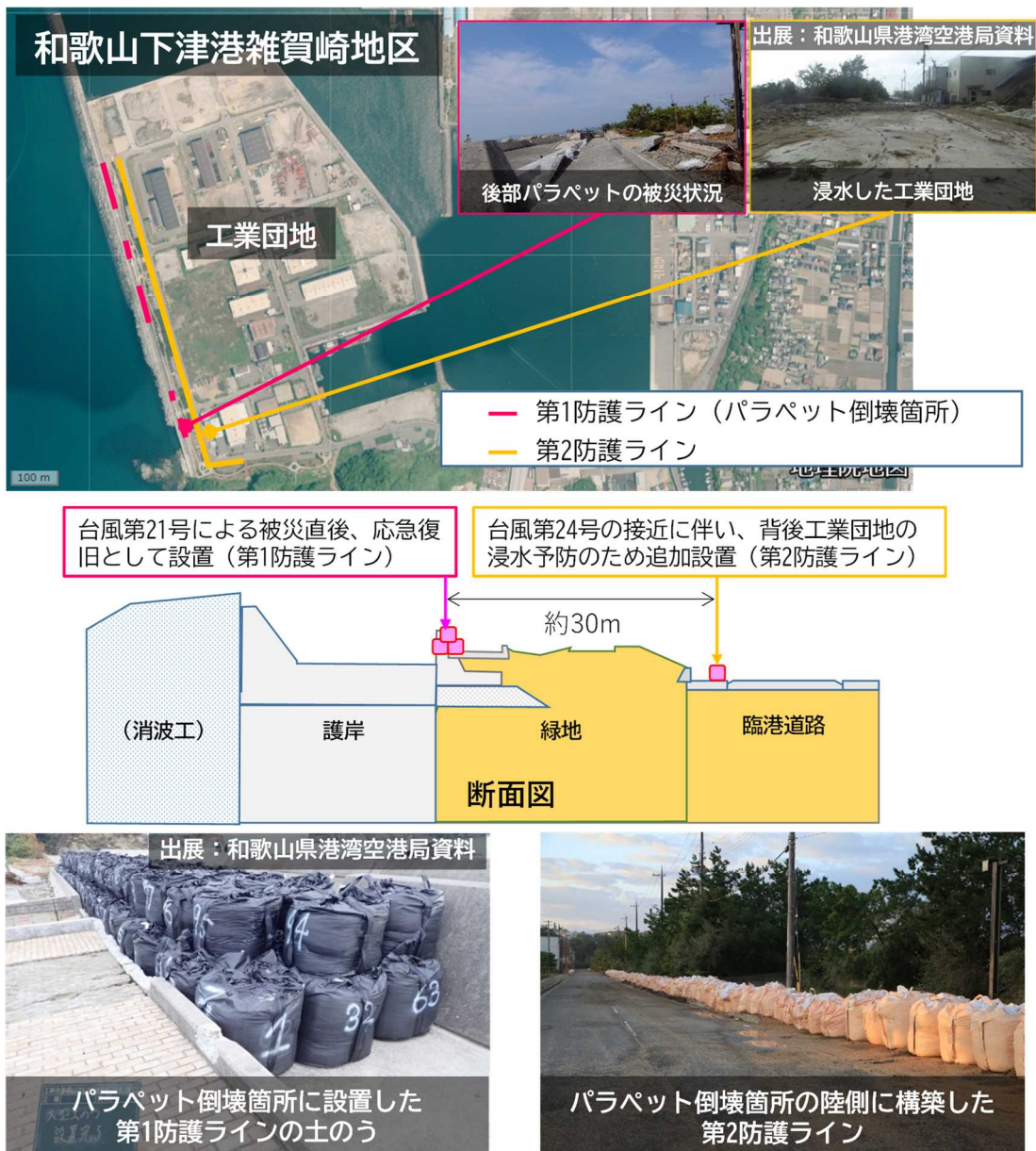
図1 和歌山下津港での土のうの設置状況
