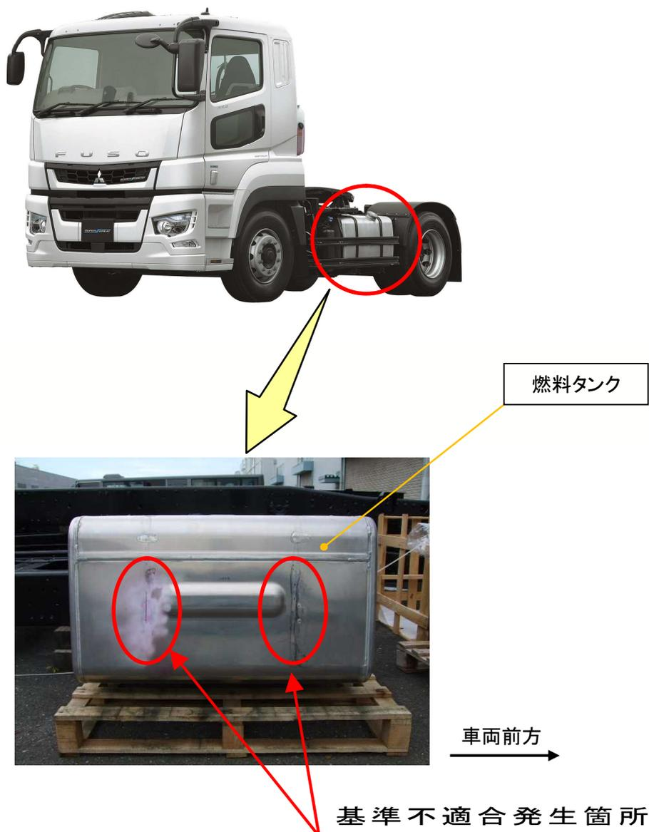
400 リットルのアルミニウム製燃料タンクを搭載した大型トラックにおいて、当該燃料タンクの強度が不足しているため、走行時の振動によりタンクの溶接部に亀裂が生じるものがある。そのため、そのままの状態を使用を続けると、亀裂が進展して燃料が漏れるおそれがある。
