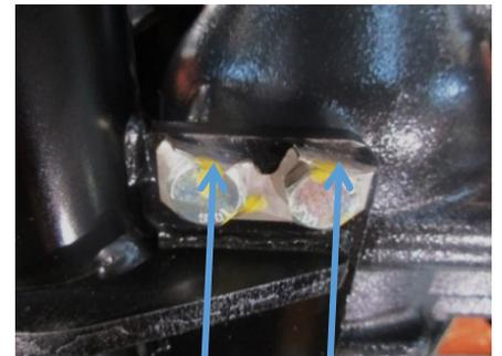
ボルト締め付後、回り止め座金を折り曲げる。
