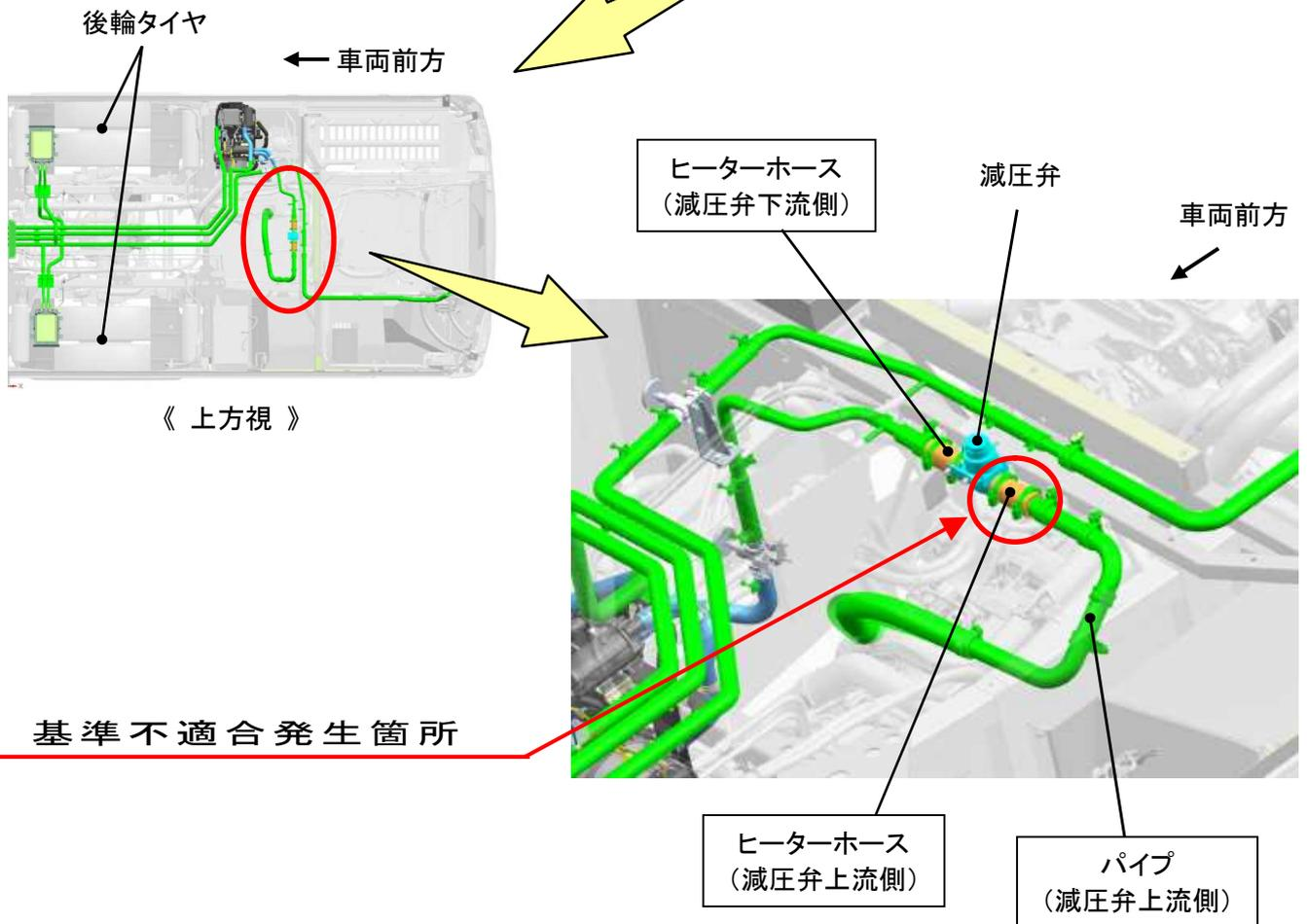
大型観光バスにおいて、ヒーターホースの耐久性が不足しているため、早期にヒーターホースが破損するものがある。そのため、冷却水が漏れ、そのまま走行を続けるとオーバーヒートに至るおそれがある。
