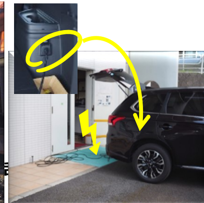
PHVからの給電：老人ホームで洗濯機・洗濯乾燥機に使用 出典：三菱自動車工業株式会社
