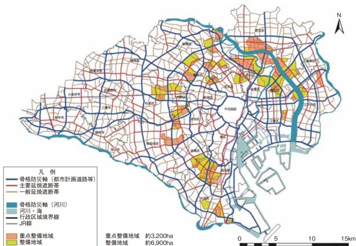
図表2-2-8 東京都の整備地域・重点整備地域（不燃化特区）・延焼遮断帯の図
