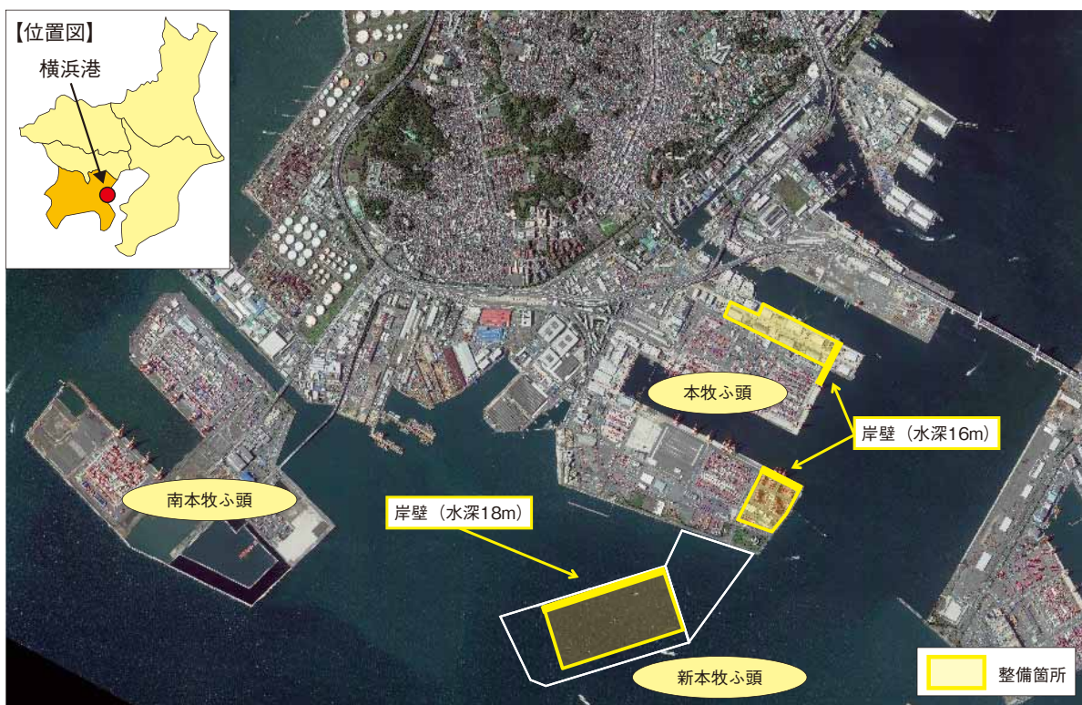
図表2-4-4 横浜港国際海上コンテナターミナル再編整備事業（大水深コンテナターミナル）
