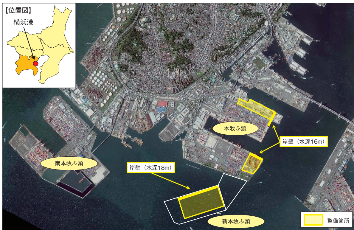
図表2-4-3 横浜港国際海上コンテナターミナル再編整備事業（大水深コンテナターミナル）
