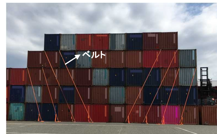
ベルトによる空コンテナの固縛の状況 (8本使用)
