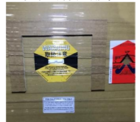
▼ショックウォッチとティルトウォッチ （貨物の外装に設置）
