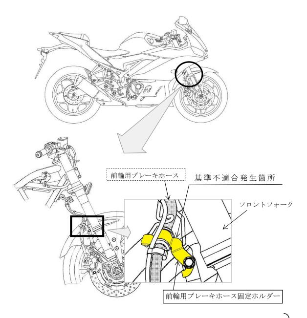
前輪用ブレーキホースを固定するホルダーにおいて、当該ホルダーの曲げ加工が不適切なため、正しい状態で取り付けられていないものがある。そのため、走行振動等により当該ホルダーが外れ、そのままの状態で使用を続けると、ブレーキホースがフロントフォークに接触して当該ホースが損傷し、最悪の場合、ブレーキ液が漏れ、制動力が低下するおそれがある。
