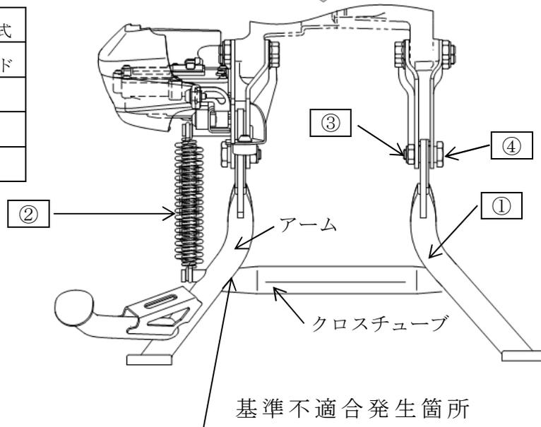
センタースタンドのアームとクロスチューブの左側溶接部において、溶接指示が不適切なため、強度が不足しているものがある。そのため、センタースタンドを立てる操作を繰り返すと、当該溶接部に亀裂が生じ、最悪の場合、当該溶接部が破断してセンタースタンドを操作した際に車両が転倒するおそれがある。
