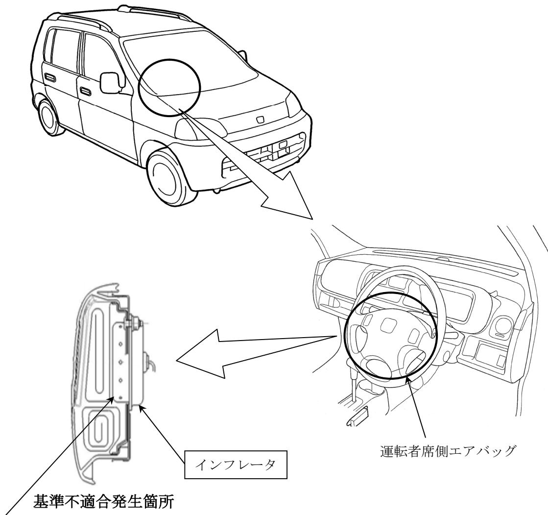
運転者席側エアバッグのインフレータ（膨張装置）において、吸湿防止が不適切なため、ガス発生剤が吸湿することがある。そのため、使用過程でガス発生剤が吸湿や乾燥を繰り返した場合など、エアバッグ作動時に正常に展開しないおそれがある。
