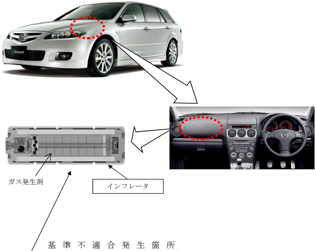
助手席側エアバッグのインフレーター(ガス発生装置)において、ガス発生剤が湿気のある状態で長期間の温度変化にさらされると劣化することがある。このため、エアバッグ展開時にインフレーター容器が破損するおそれがある。
