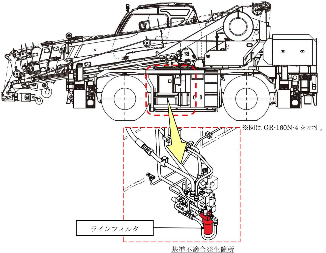
ホイール・クレーンの作動油ラインフィルタにおいて、誤った材質のフィルタヘッドが組み付けられているため、強度が不足しているものがある。そのため、ラインフィルタが損傷し、作動油が漏れ、最悪の場合、ラインフィルタが脱落し他の交通の妨げとなるおそれがある。なお、一部の車種においては、操舵力が増大するおそれがある。
