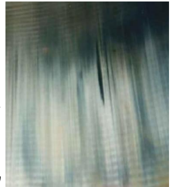
図3-2 ポアポリッシュが発生し一部ウェーブカットの溝が無くなったシリンダライナ
