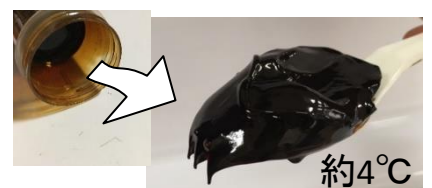
動粘度(50°C)が24.5cSt程度のサンプルLSC重油を約4°Cまで冷やしたもの
