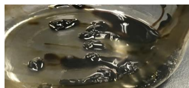
フィルターに詰まっていたゲル状のスラッジ
