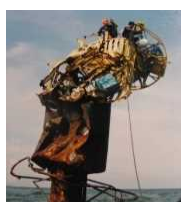
損傷した浮体式灯標
