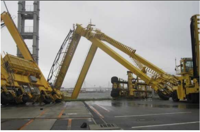
トランスファークレーンの倒壊
