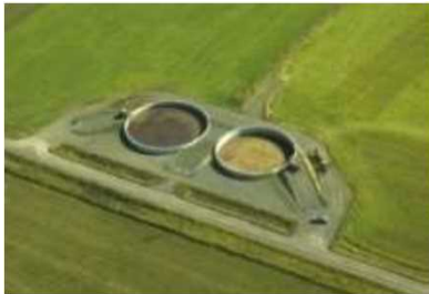
肥培かんがい施設の整備 (家畜排せつ物を肥料として効率的に農地還元)
