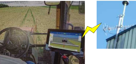
農地の大区画化と併せて、町がRTK-GNSS*基地局を設置し、農業機械の位置情報の精度を大幅に改善。 写真提供: 今金町
