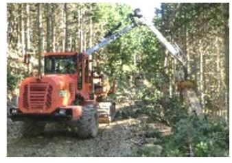
丸太を集材して林内運搬可能な「フォワーダ」
