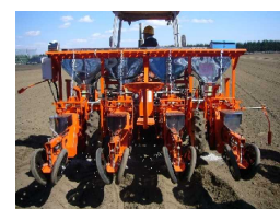
高性能直播機 (労働負担が大きい移植作業を省力・低コスト化)
