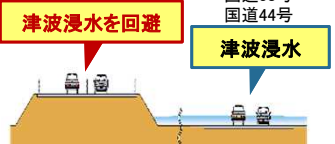
国道38号、44号付近の津波浸水を回避し、災害時における迅速な避難及び救援活動が可能。
