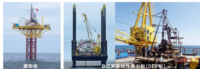
掘削・貫入試験で使用する機材例
