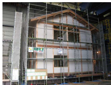
振動台実験 試験体例
