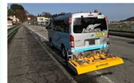
水の早期検知技術 (車載式電磁波レーダ： 80km/hまで調査可能)
