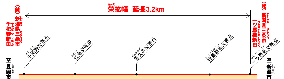
【計画縦断面図】※縦断線形は現況(LEVEL~0.1%)を維持
