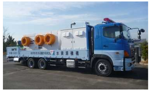
災害用応急ポンプ車
