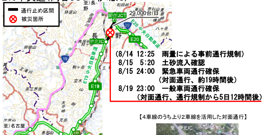
【中央自動車道被災状況(土砂流入)】
