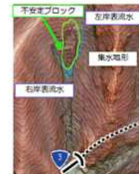
災害箇所におけるレーザープロファイラ調査結果
