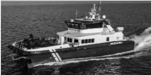
欧州仕様の作業船(CTV)
