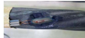
写真-6 ひずみゲージの貼付け(両面)
