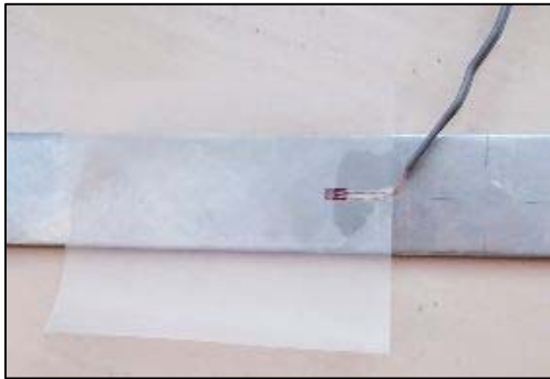
写真-3 センサ(ひずみゲージ)の貼付け
