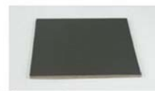
模擬段差 □100×100mm 厚さ 0.5~5.0mm
