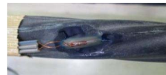
写真-6 ひずみゲージの貼付け(両面)
