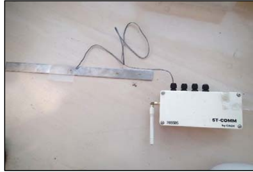
写真-4 センサと通信機の接続
