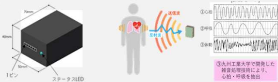
電波型人感センサ（心拍数・呼吸数・体動を測定）
