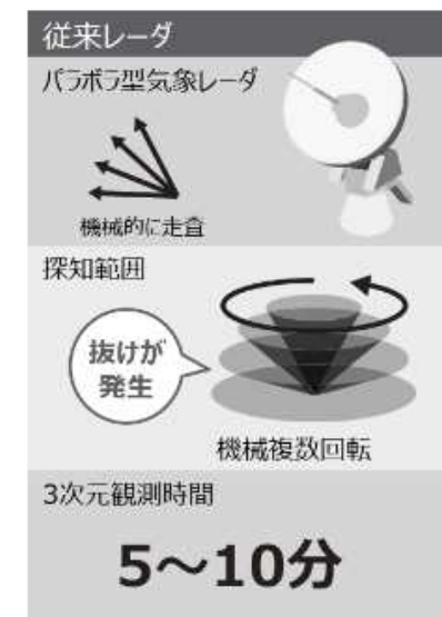
従来のパラボラ型レーダとフェーズドアレイ気象レーダの比較
