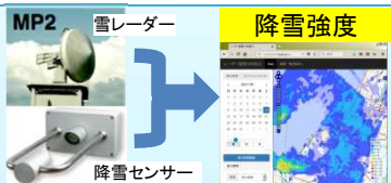
雪レーダーと降雪センサーを用いた高精度降雪量測定アルゴリズムの研究開発
