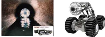
テレビカメラによる管路の点検・調査
