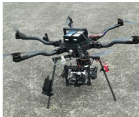
<赤外線装置を搭載したドローンによる打診検査>
